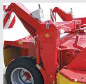
Разгрузочные пружины, расположенные под углом, в комбинации с телескопической верхней тягой обеспечивают лучшее прощупывание почвы, даже при высоких рабочих скоростях.
