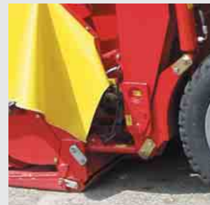
Рычаг вблизи почвы для оптимального копирования почвы.
