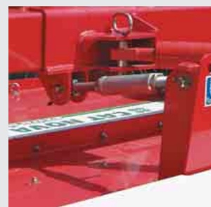
Телескопическая верхняя тяга регулируется для оптимальной подгонки косилочной балки к неровностям местности в направлении движения.
