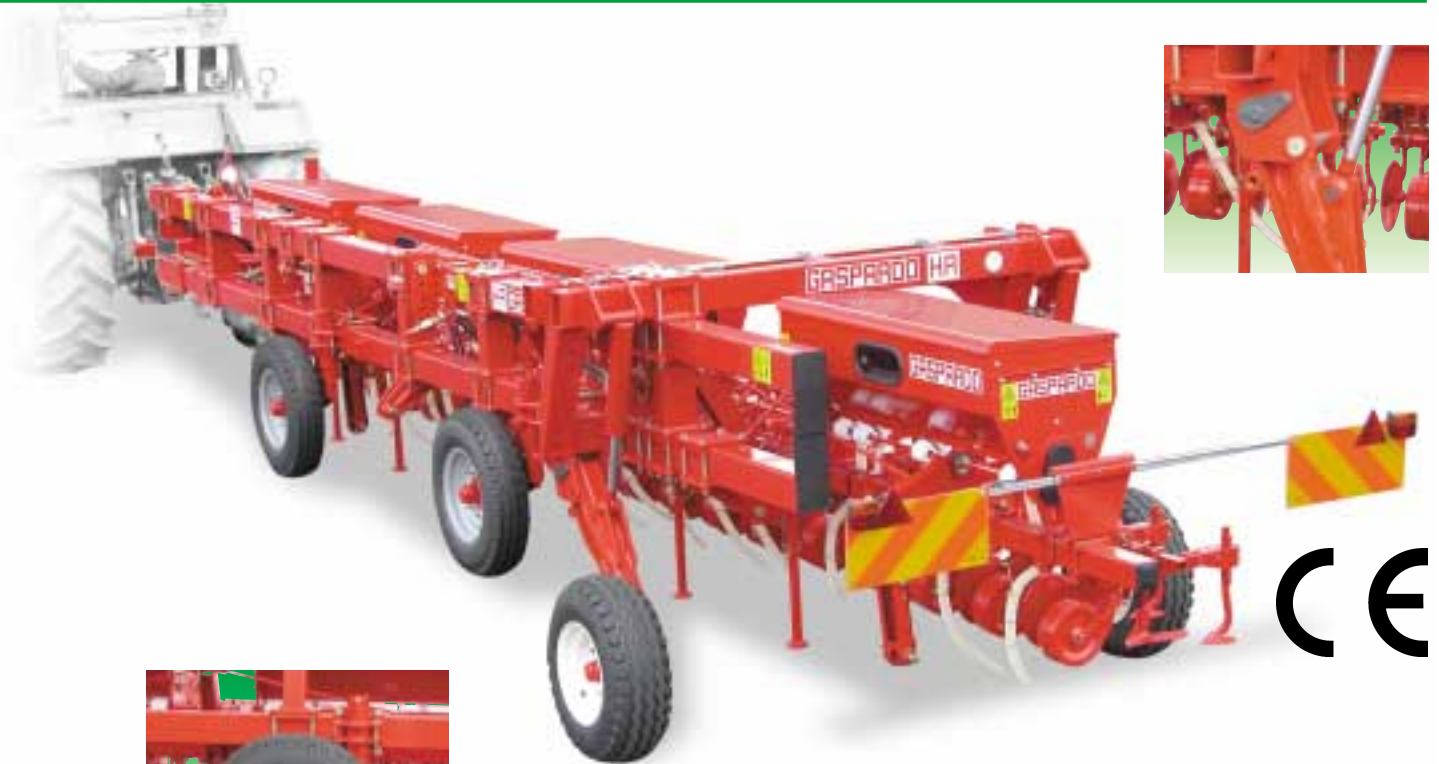
Ruote anteriore per regolazione profondità di lavoro Front wheels for working depth adjustment Jeu de roues avant réglage profondeur de travail Vordere Stützräder für Arbeitstiefenregulierung Ruedas delanteras regulación profundidad de trabajo
