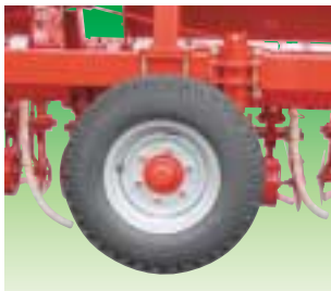
Ruote anteriore per regolazione profondità di lavoro Front wheels for working depth adjustment Jeu de roues avant réglage profondeur de travail Vordere Stützräder für Arbeitstiefenregulierung Ruedas delanteras regulación profundidad de trabajo
