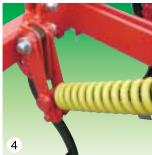
Деталь системы безопасности на пружине Reglaj sistem de siguranță pe arc Rugós biztossági rendszer Pružinové pojistné zařízení Sprężynowy system zabezpieczenia
