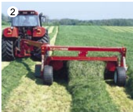
2 Косилки от JF-STOLL с шириной захвата от 1,7м до 12м могут широко рассыпать траву и укладывать как одинарные, так и двойные валки
