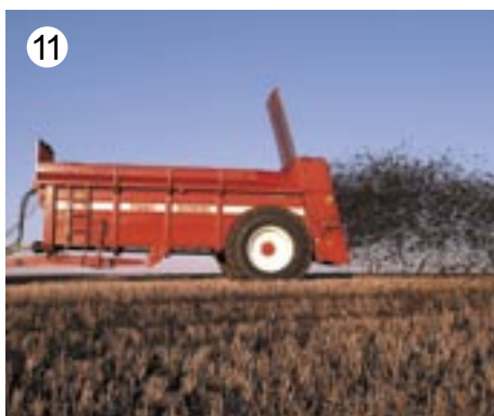
11 Прочный разбрасыватель компоста имеет два мощных вертикальных вала для разбрасывания твердого компоста.
