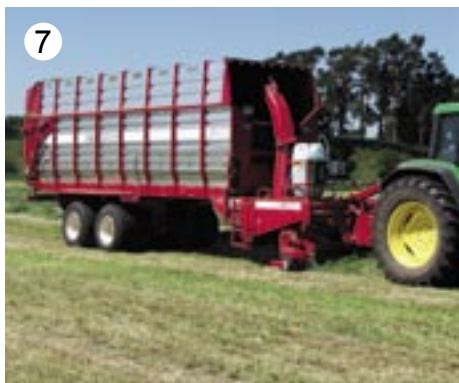
7 Кормоуборочный комбайн JF-STOLL (подборщик – измельчитель + транспортный вагон) позволяет вести заготовку корма с использованием только одного трактора и обеспечивает высокую производительность
