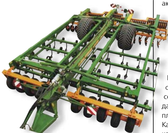
Комбинация культиватор-дисковая борона Centaur: от поверхностного перемешивания до глубокого рыхления.
