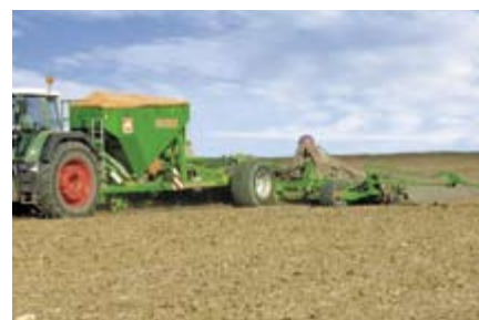
Сеялка Citan (до 12 м.) работает без почвообрабатывающих рабочих органов. Система дозирования производится на выбор: механически или электронно.
