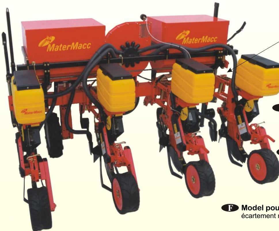
**I** Modello con telaio fisso larghezza di lavoro fino a 9 m., interfila min. 28 cm.
