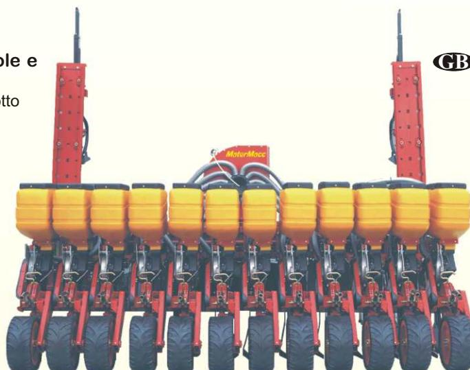
**F** Model avec châssis repliable hydraulique et système EASY-SET
