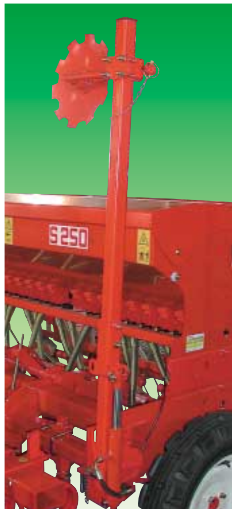
Маркер рядов с гидроприводом с предохранительным штырем и зубчатым диском Marcator rânduri și acționare hidraulic cu pivot de siguranță și disc dințat Oleodinamikusan vezérelt sorjelző fogas tárcsával és biztosító csapszeggel Hydraulický značkováč řádků s pojistným kolíkem a ozubeným diskem Znacznik rzędów sterowany oleodynamicznie ze sworzniem zabezpieczającym i tarczą zębatą
