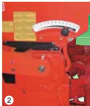
Передача для распределения семян Schimb pentru distribuția semințelor A vetőmag-elválasztó sebességváltója Převodovka pro distribuci osiva Skrzynka biegów do rozdzielania nasion
