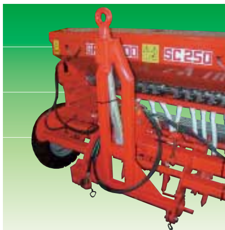
Дышло для прицепного варианта Timonă pentru versiunea remorcată Akasztó rúd kapcsoló verzióban Tažná tyč pro taženou verzi zařízení Belka zaczepowa w wersji doczepianej
