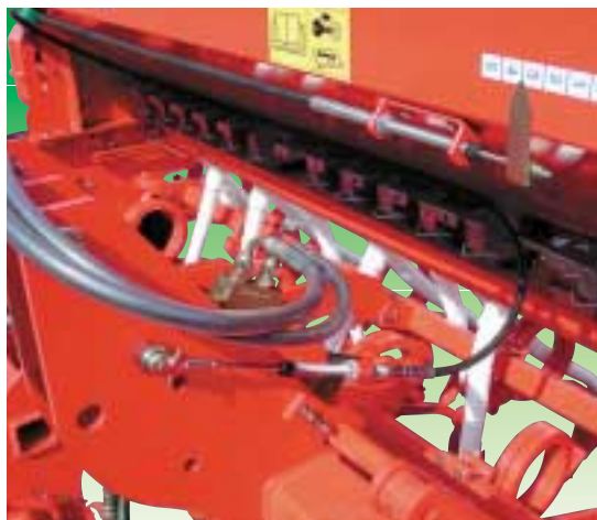
Гидродинамическое регулирование глубины Reglaj hidraulic profunzime Oleodinamikus mélységszabályozó Hydraulické nastavení hloubky Regulacja oleodynamiczna głębokości
