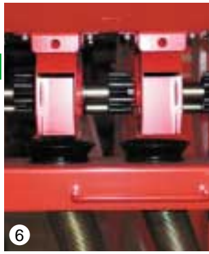
6 Распределение семян роликом с желобком Distribuție semințe cu cilindru cu caneluri Magszétválasztás faragott görgővel Válec k distribuci osiva Rozdzielanie nasion żłobioną rolką
