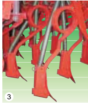
Гибкий борозделатель Brăzdăr elastic Elastikus eke Elastické zařízení pro otevření žlábků Redlica elastyczna
