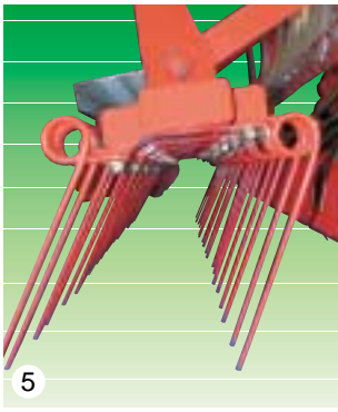
5 Борона, закрывающая семена, с двойным рядом Grapă acoperitoare de semințe cu dublu rând Kiegészítő kétsoros borona Brány k prikrývání osiva Brona niwelująca dwurzędowa
