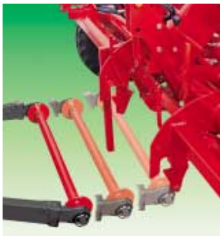
Стержень быстрого крепления Bară cuplaj rapid Gyorskapcsoló rudja Rychlospojka Drażek do szybkiego łączenia
