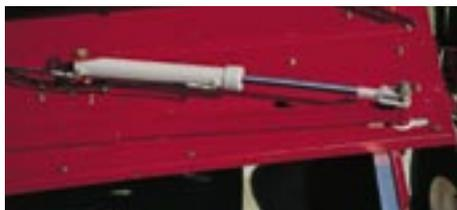
Гидравлика обеспечивает синхронное движение валкообразующих щитков и дышла.
