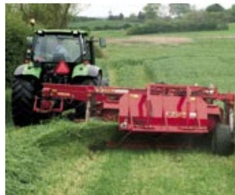
2. Валок, образованный опущенным коллектором. Возможно доп.оборудование дистанционным управлением, для регулирования скорости транспортера из кабины трактора.
