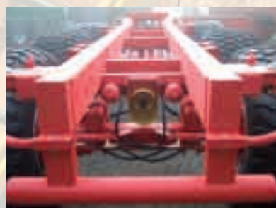
Ходовая часть тридем с серийным сквозным приводом BOM для кузовных приводов
