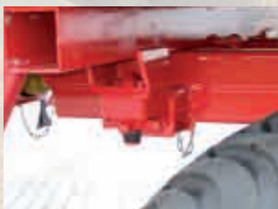
Система блокировки Twist-Lock с креплением установочных опор
