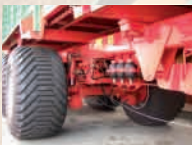
Ходовая часть тандем с гидравлической подвеской и системой блокировки Twist-Lock
