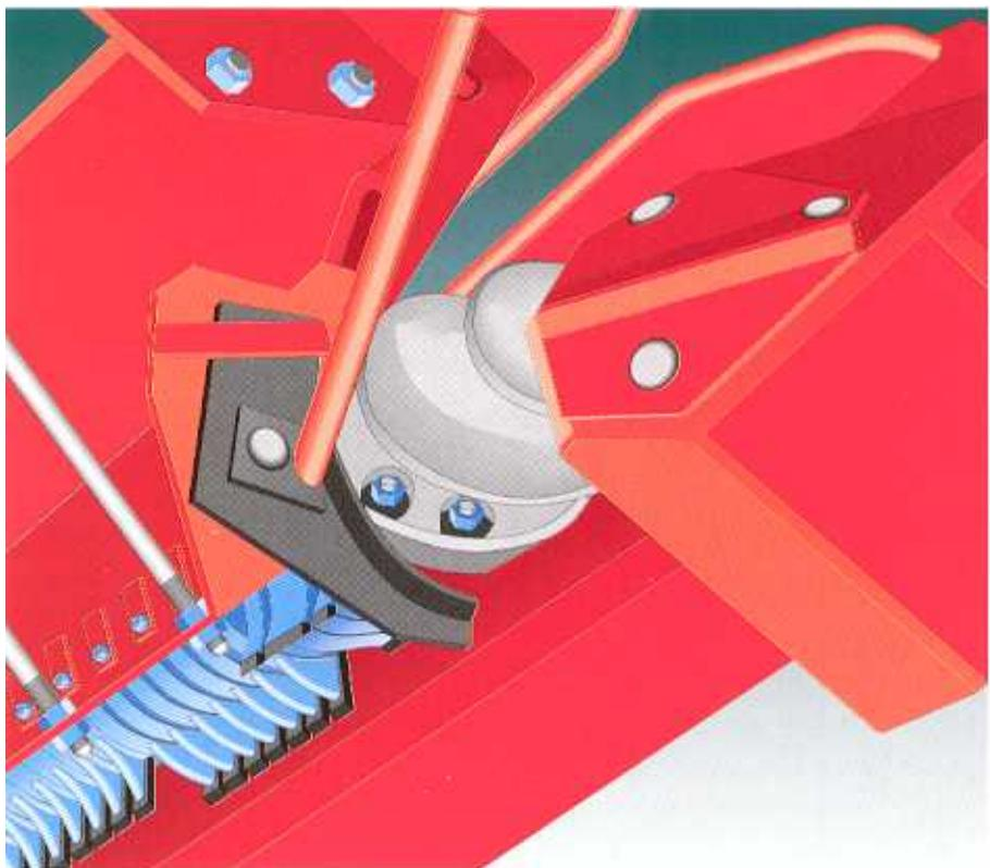
Возможность легкого доступа к уборочным рядам с целью проведения техобслуживания и ухода является предпосылкой большого срока службы. Кожухи и носки делителя могут легко сниматься без использования инструмента. Наглядно расположенные узлы позволяют легко проверять настройку. Все уборочные ряды имеют единообразное исполнение и взаимно заменяемы. Приводное соединение между рядами осуществляется через гибкие соединительные элементы.
