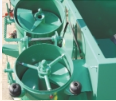
Большой диаметр шнека с центральным расположением
