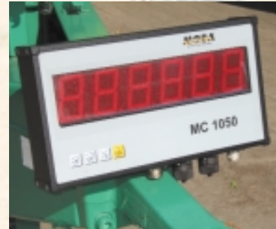
Дисплей компьютера дозирующего устройства для кабины трактора
