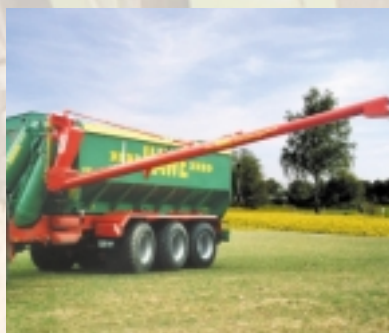
Шнек семенного зерна в комбинации с сеялкой при ширине более 6 м.
