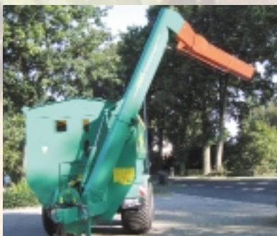
Гидравлическая регулировка спускного желоба для рядовой сеялки с рабочей шириной до 6 м.
