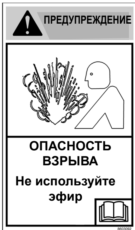
НАКЛЕЙКА НА ВЕРХНЕЙ КРЫШКЕ ВОЗДУХООЧИСТИТЕЛЯ ДВИГАТЕЛЯ И ВОЗДУШНОЙ ВЫВОДНОЙ ТРУБЕ (T9010-T9040)
